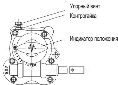
Винт-ограничитель позволяет устанавливать положение «Закрыто» с точностью ±5 град.
